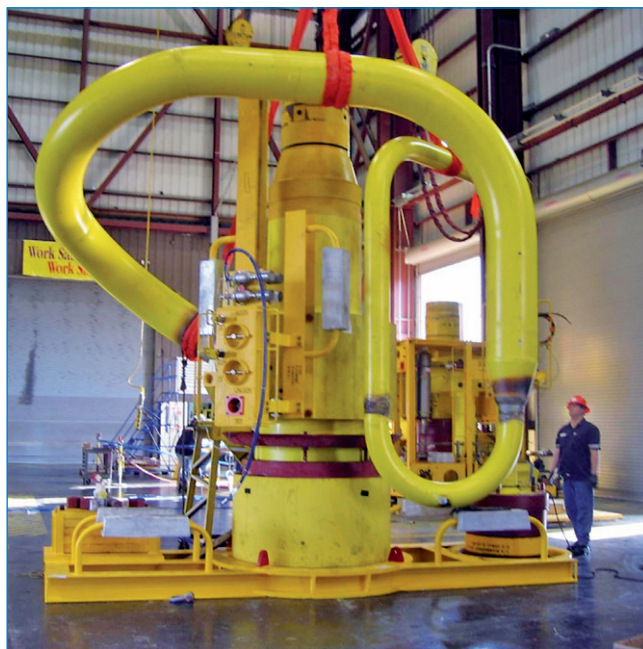
Рис. 2. Сепарационная установка проекта Perdido
