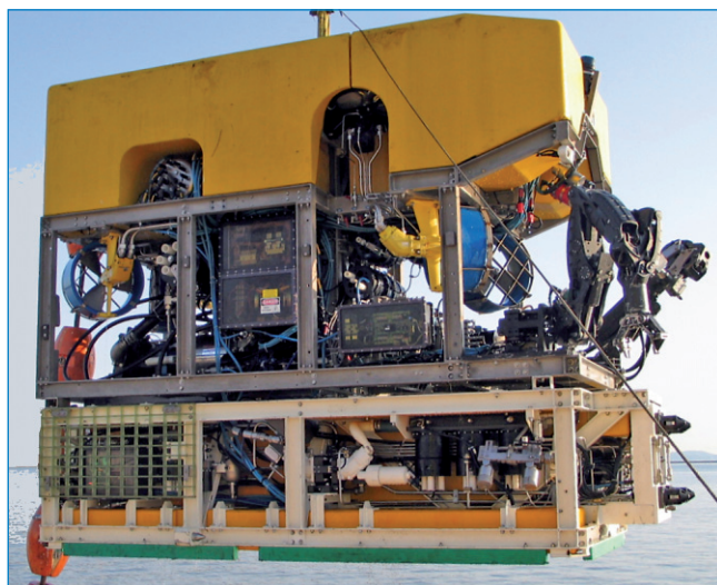
Рис. 1. Рабочий подводный автономный аппарат с изолированным гидросиловым блоком
