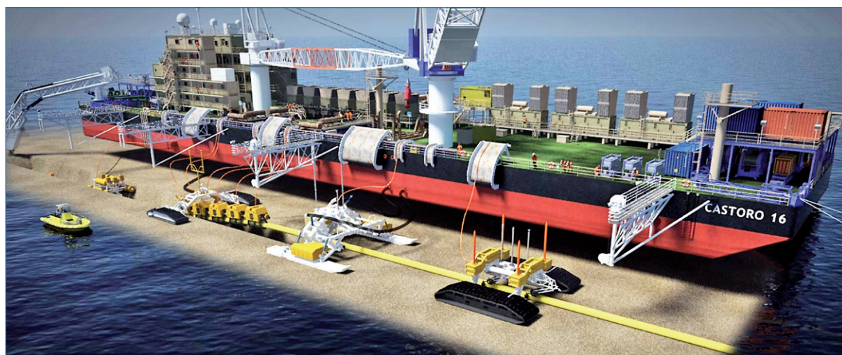
Рис. 2. Траншеекопательное оборудование баржи Castoro 16
