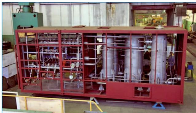
Рис. 1. УСПГ высокого давления ООО «КриоМаш-БЗКМ»
