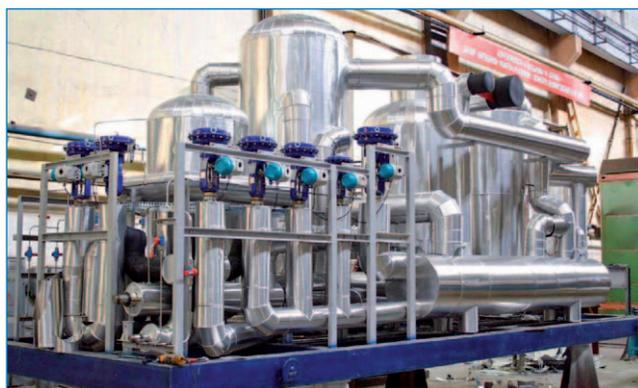
Рис. 2. УСПГ высокого давления ОАО «Криогенмаш»
