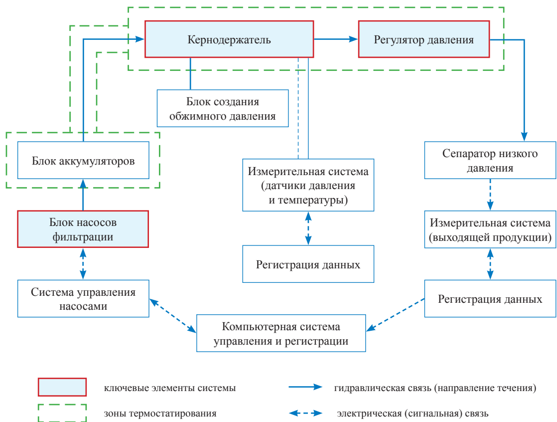
Рис. 1. Функциональная блок-схема экспериментальной установки двухфазной фильтрации
