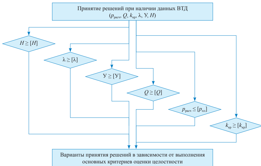
Рис. 2. Схема принятия решений для объектов ЛЧ МГ при наличии достаточных данных о дефектах ( k_{кр} – критерий капитального ремонта протяженного участка ЛЧ МГ; доля ремонта заменой труб)
