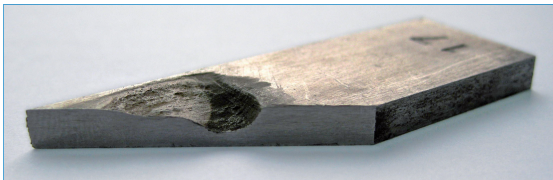
Рис. 1. Коррозионный дефект под действием постоянного блуждающего (анодного) тока на образце, расположенном в водной среде под углом 45° (в разрезе)
