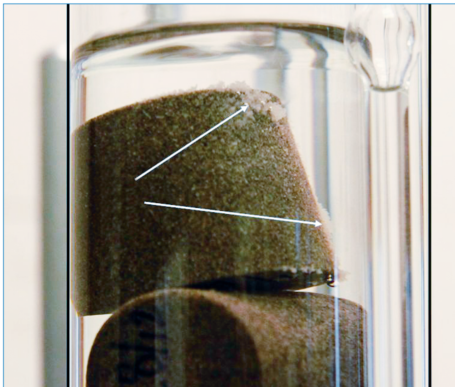
Рис. 10. Вымывание соли из порового пространства образца при экстракции толуолом
