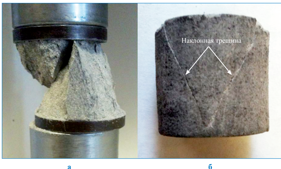
Рис. 1. Разрушенные образцы керна: а – после одноосного нагружения; б – после трехосного нагружения
