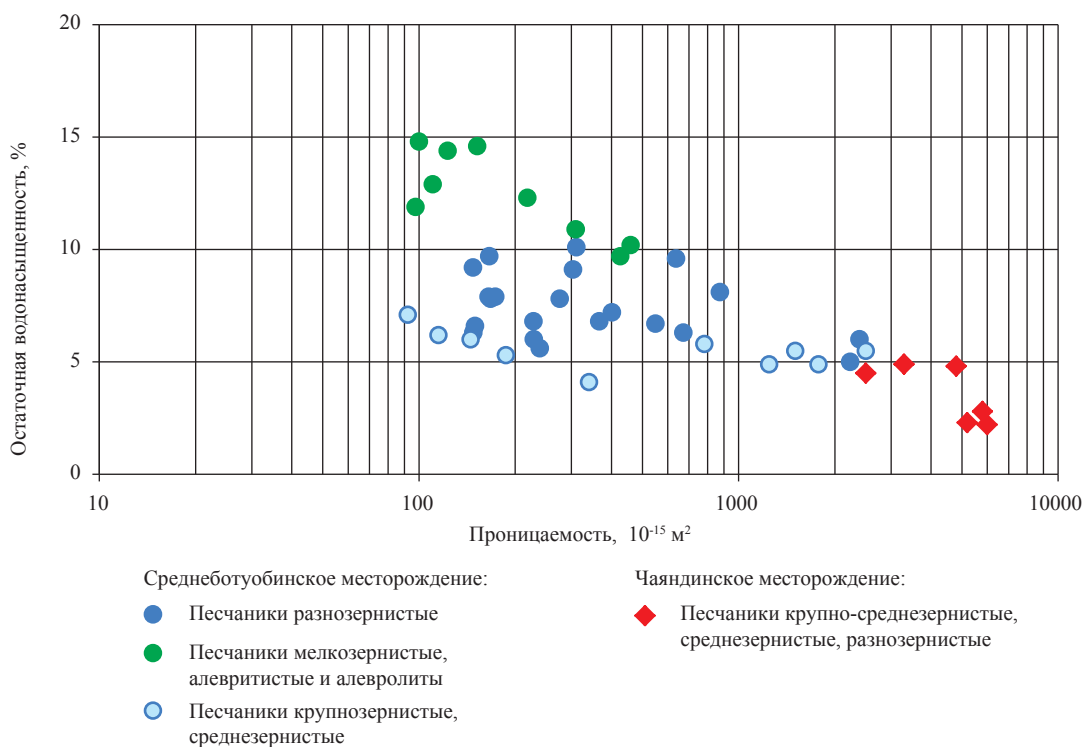
Рис. 11. Зависимость содержания остаточной воды от проницаемости для пород-коллекторов ботубинского горизонта по данным прямых определений по керну
