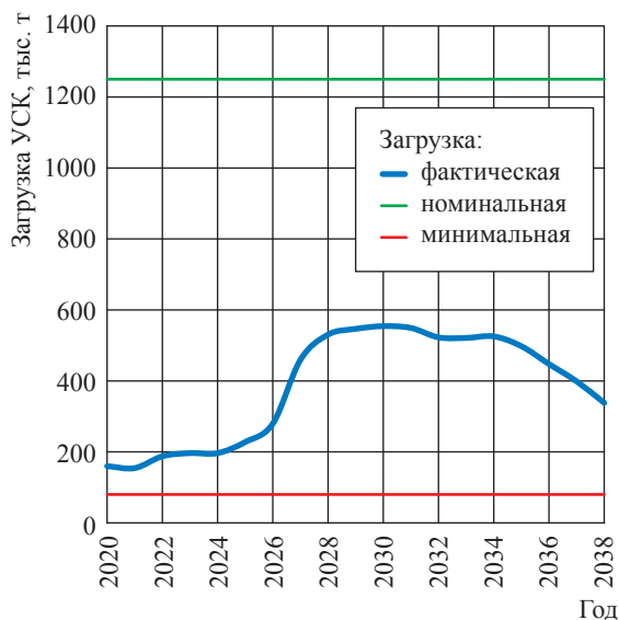
Рис. 2. Прогноз загрузки установки стабилизации конденсата жидким сырьем
