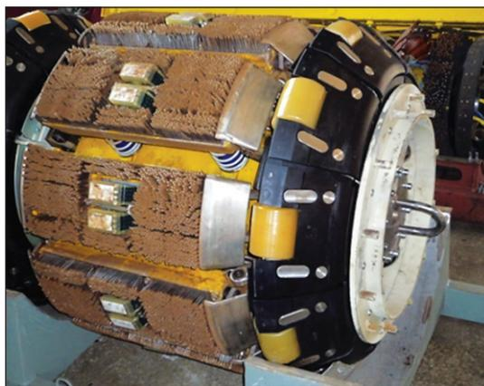
Рис. 5. Магнитный дефектоскоп диаметром 1420 мм с продольным намагничиванием
