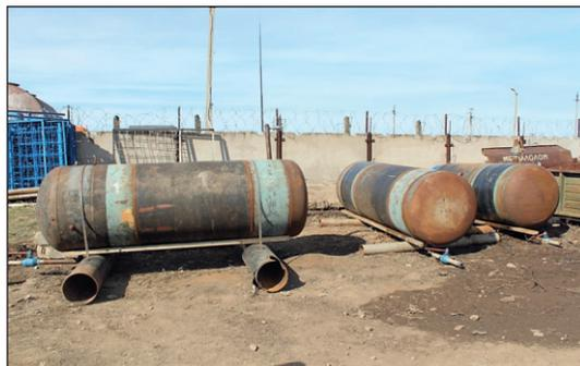
Рис. 1. Образцы катушек для испытания
