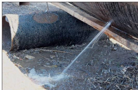
Рис. 3. 100-миллиметровый разрыв образца K2 в продольном направлении с раскрытием шириной 1 мм в зоне участка вздутия
