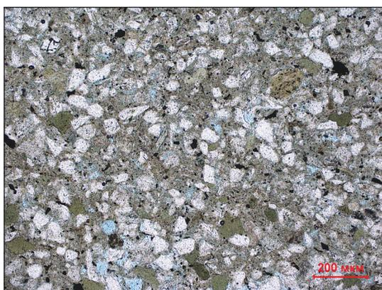
Рис. 1. Шлиф алевролита мелко-крупнозернистого глинистого без анализатора,  $\times 100$ . Пласт ВБ<sub>1</sub>
