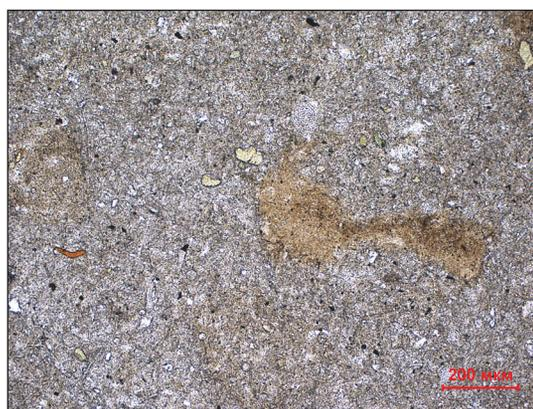
Рис. 2. Шлиф опоки глинистой без анализатора,  $\times 100$ . Пласт НБ<sub>2</sub>
