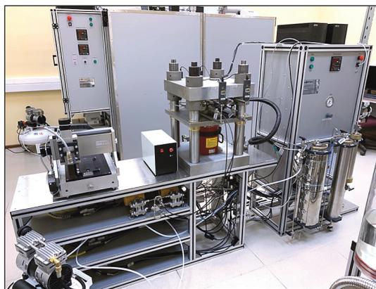
Рис. 4. Блок ГРП: исследования проводимости пропантной упаковки
