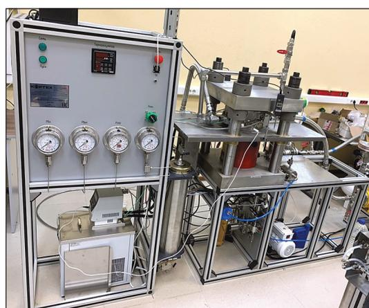
Рис. 5. Блок ГРП: исследования процессов выноса пропанга
