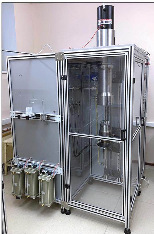
**Рис. 2. Блок ГЕО: исследования деформационно-прочностных свойств образцов керна**
