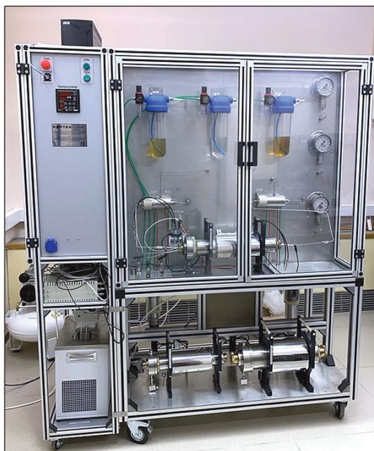
**Рис. 3. Блок ГЕО: исследования петрофизических свойств образцов керна**
