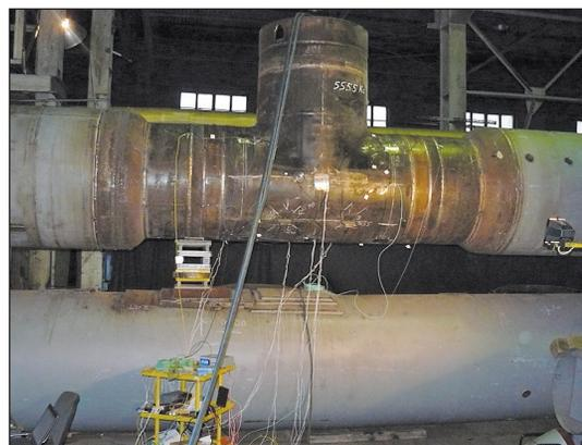
Рис. 4. ИЭ (тройник) в составе испытательного стенда
