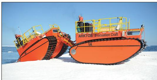
**Рис. 34. Многоцелевой арктический вездеход-амфибия**
