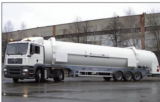
**Рис. 2. Автотранспортная цистерна жидкого водорода объемом 45 м<sup>3</sup>**
