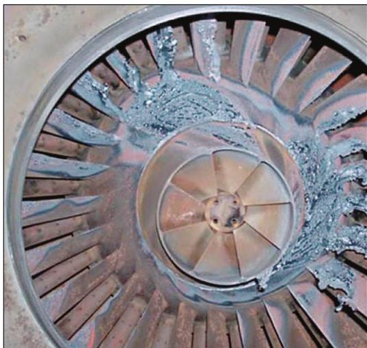
Рис. 4. Повреждение газовой турбины при просжке пламени
