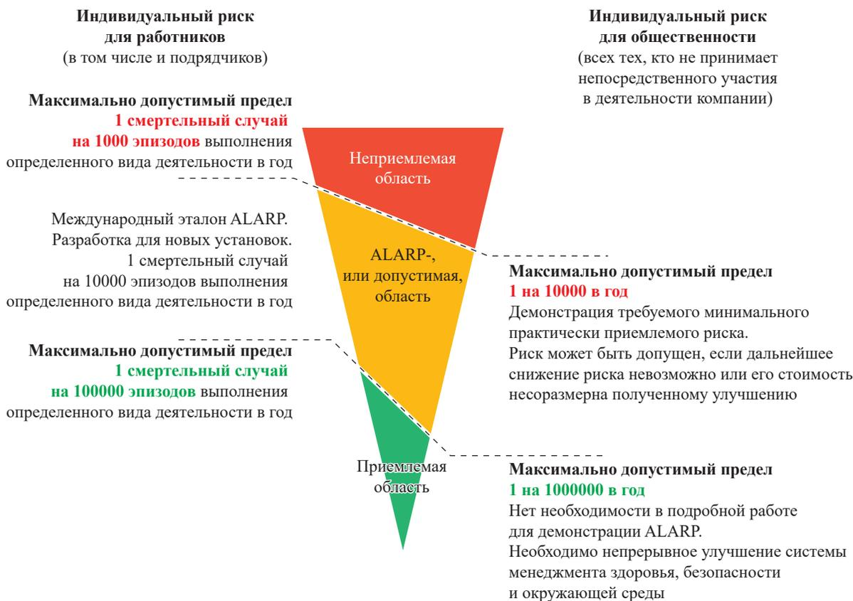
Рис. 1. Графическое отображение принципа ALARP
