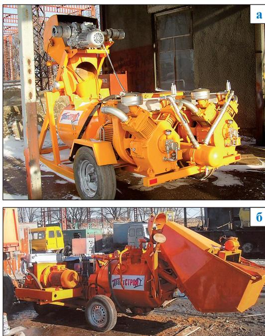
Рис. 6. Механизированный комплекс в системе «Экобетон»: а – вид спереди; б – вид сзади
