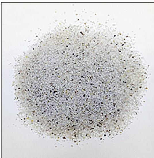
**Рис. 2. Сухой остаток после воздействия СРКО на образец натурального кольматанта**
