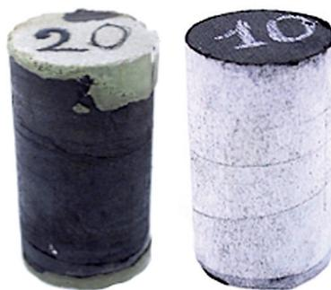
**Рис. 3. Применяемые при исследовании физико-механических свойств угольного керна методы борьбы с нестабильностью материала: восстановление торцов (слева) и компенсация бокового распора (справа)**
