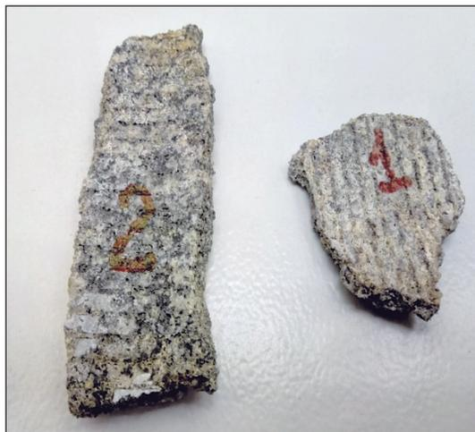
**Рис. 1. Образцы натурального кольматанта типичного карбонатного типа**
