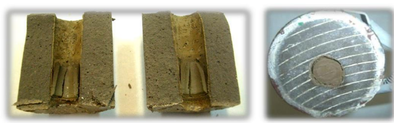
Рисунок 2.5 – Фотографии образцов тампонажных камней из СУТМ 1560 – 50.
