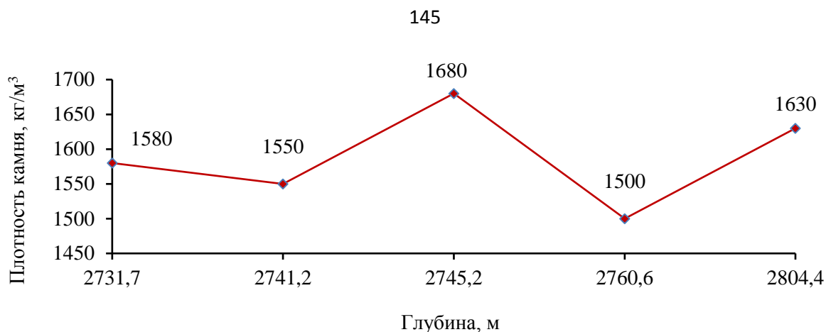
Рисунок 3.2 – Результаты радиоактивной цементометрии эксплуатационной колонны в скважине Узунской площади ОАО "Славнефть – Мегионнефтегаз".
