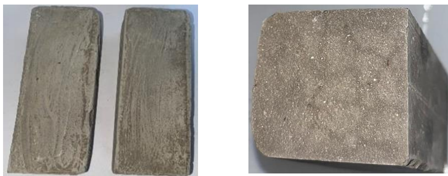
Рисунок 2.33 – Мелкопоризованный облегченный тампонажный камень после 5 циклов нагрева до 250 °С – остывания до 20 \pm 2 °С.
