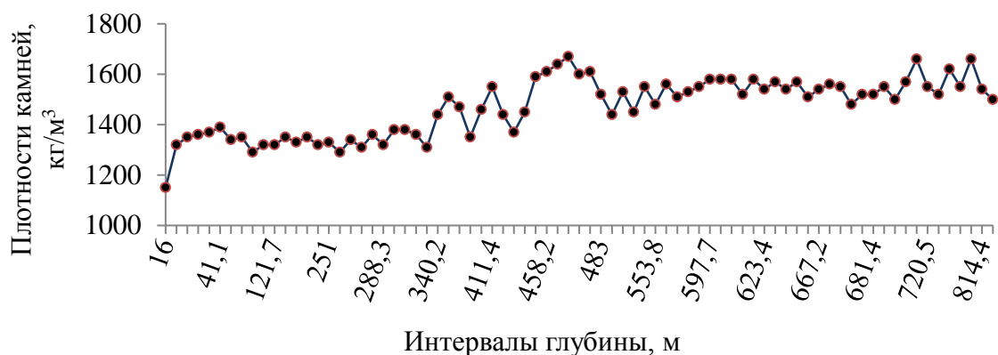
Рисунок 2.7 – Результаты радиоактивной цементометрии эксплуатационной колонны 146 мм в скв. № 28659 Карамалинской площади.
