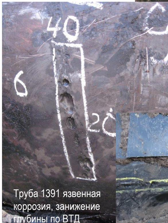
Труба 1391 язвенная коррозия, занижение глубины по ВТД
