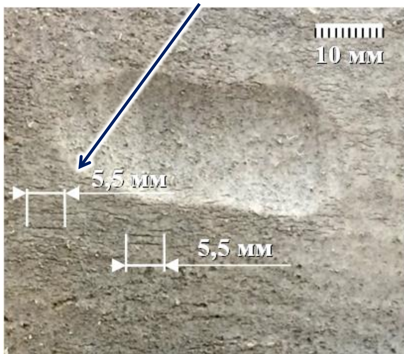
Область стресс-коррозионных повреждений сентябрь 2015
