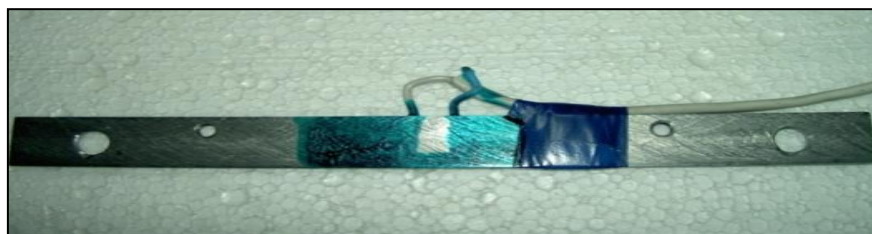
Образец балочного типа с предварительно выращенной усталостной трещиной
