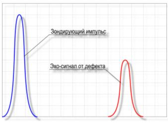
При наличии аномалии на пути распространения волны возникают эхо-сигналы, которые регистрируются той же AP, работающей в приёмном режиме. За счёт использования эффекта волноводного распространения ультразвуковых волн в стенке трубы обеспечивается контроль всего тела трубы при перемещении Сканера только по линии образующей, т.е. <u>без необходимости сканирования всей внутренней поверхности трубопровода</u>, с производительностью <u>не менее 0,5 погонных метра в минуту</u>.
