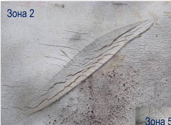
С нанесенным трещиноподобным концентратором напряжений
