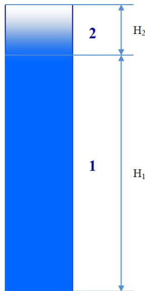
Рисунок 3.5. Распределение газожидкостной смеси по плотности в установившемся вертикальном газожидкостном потоке.
