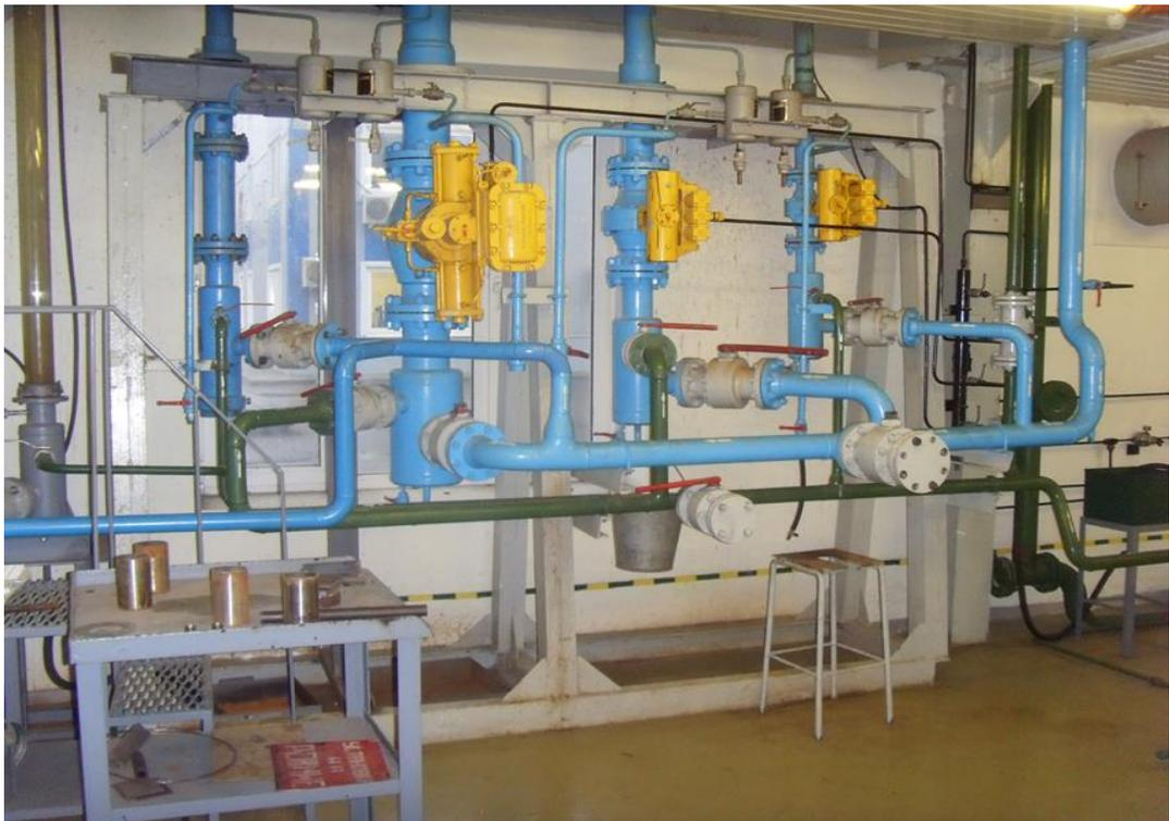
Рисунок 2.17 – 1-й этаж стенда. В желтом цвете – блоки пневматических клапанов-отсекателей
