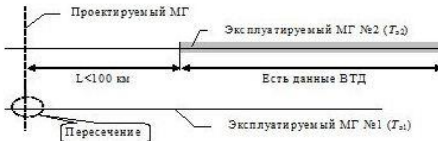
г - ВТД проведено на участке, параллельном прилегающему участку
