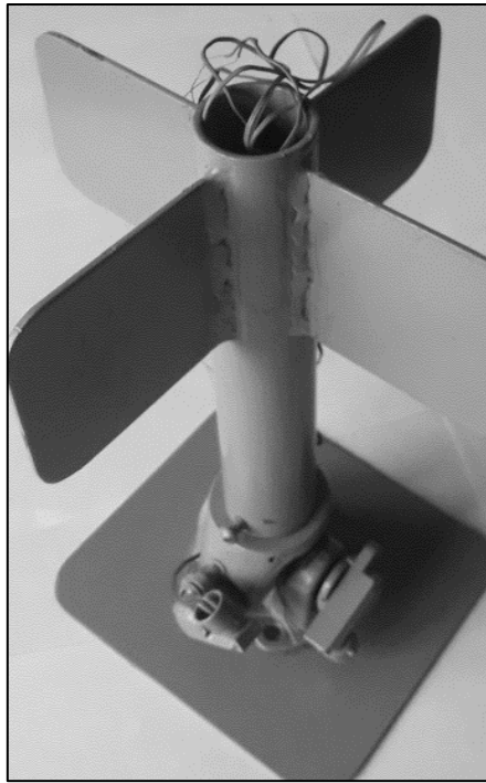
Рисунок 2.14 - Устройство для определения направления движения грунта на оползневом участке
