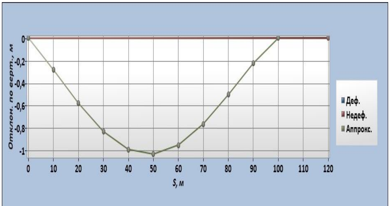
Рисунок 3.12 – Аппроксимация положения оси газопровода в вертикальной плоскости
