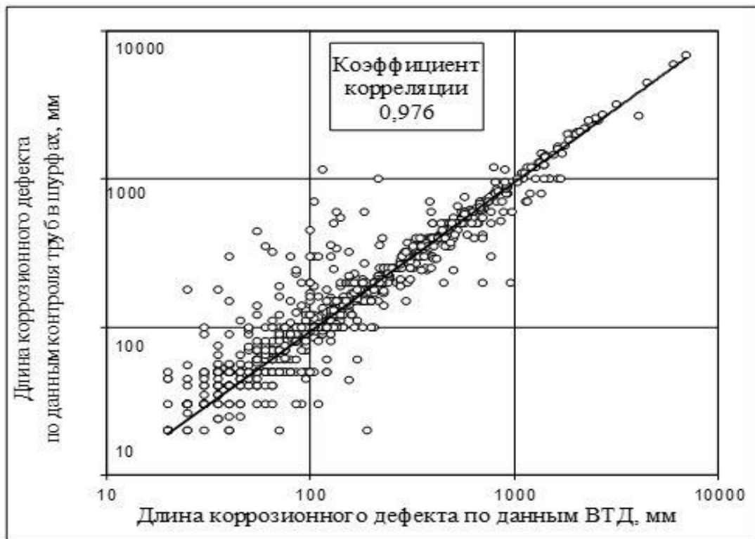
Рисунок 6.6 – Сравнение по длинам коррозионных дефектов данных ВТД 2004 г. с данными НК труб
