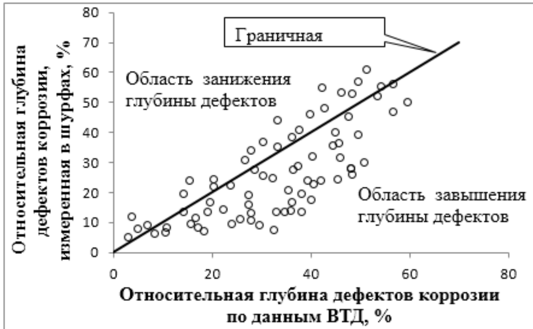
Рисунок 6.5 – Сравнение данных ВТД 2004 г. с данными НК труб в шурфах
