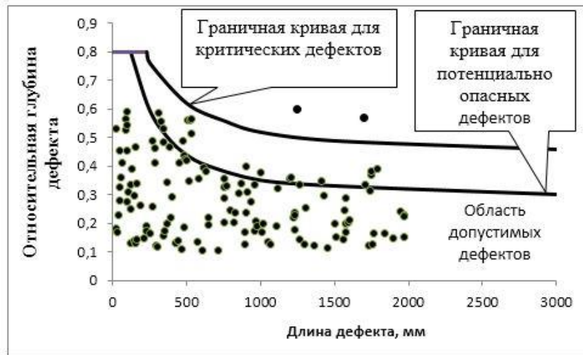
Рисунок 5.2 – Оценка степени опасности коррозионных дефектов на газопроводе диаметром 1420 мм и толщиной стенки труб 18,7 мм
