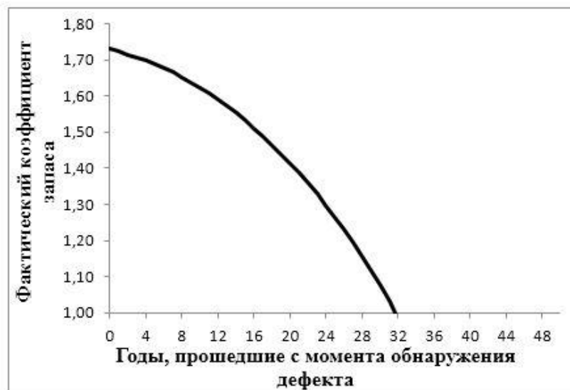
Рисунок 5.8 – График изменения коэффициента запаса газопровода с коррозионным дефектом длиной 80 мм и относительной глубиной 0,393
