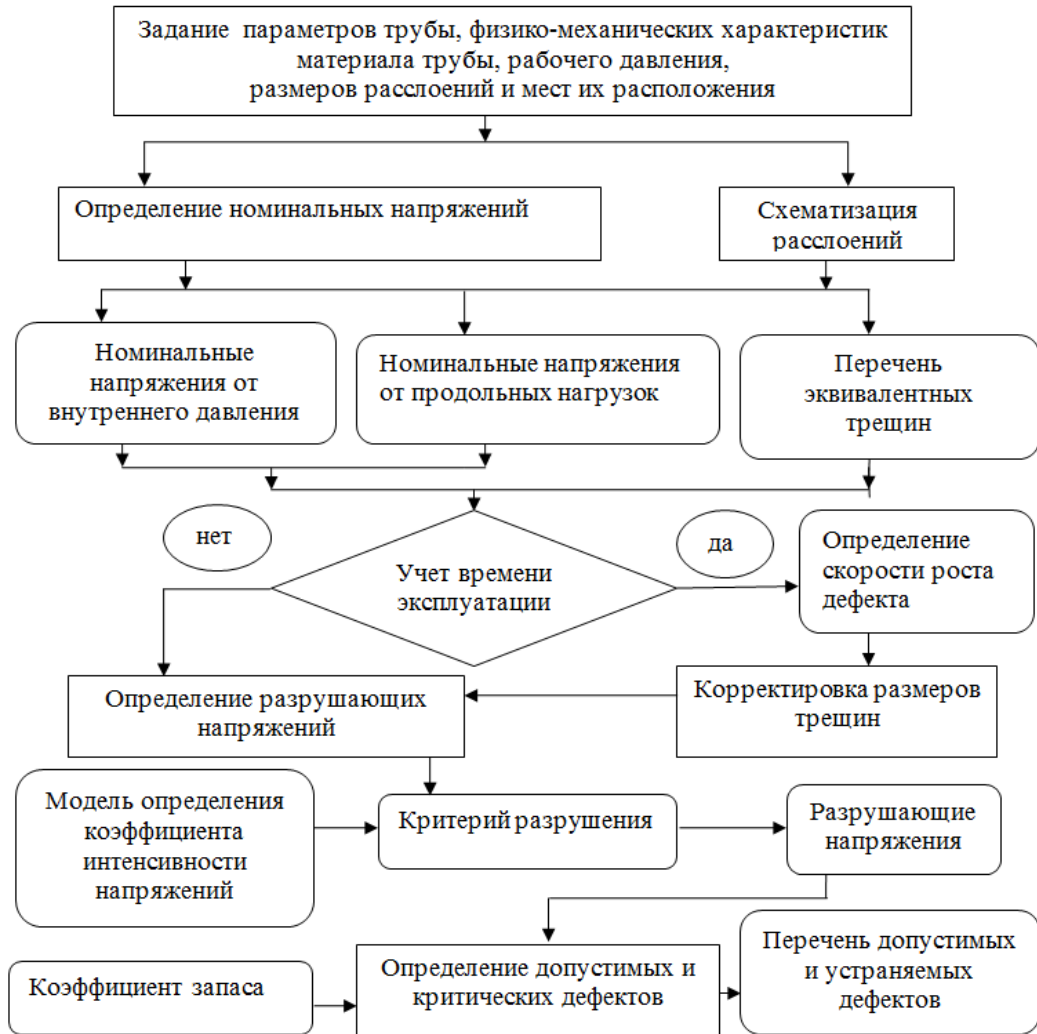
Рисунок 3.14 – Алгоритм определения допустимых и критических дефектов
