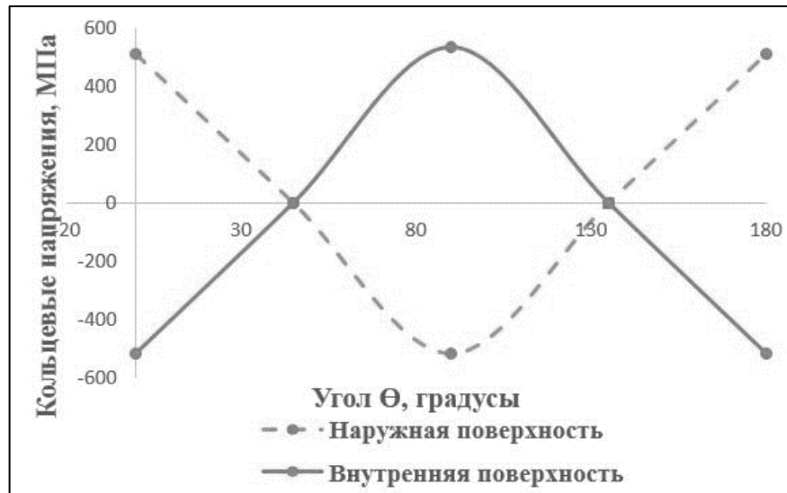
Рисунок 3.24 - Распределение напряжений на внутренней и наружной поверхностях поперечного сечения упругой расчетной модели при ПНС
