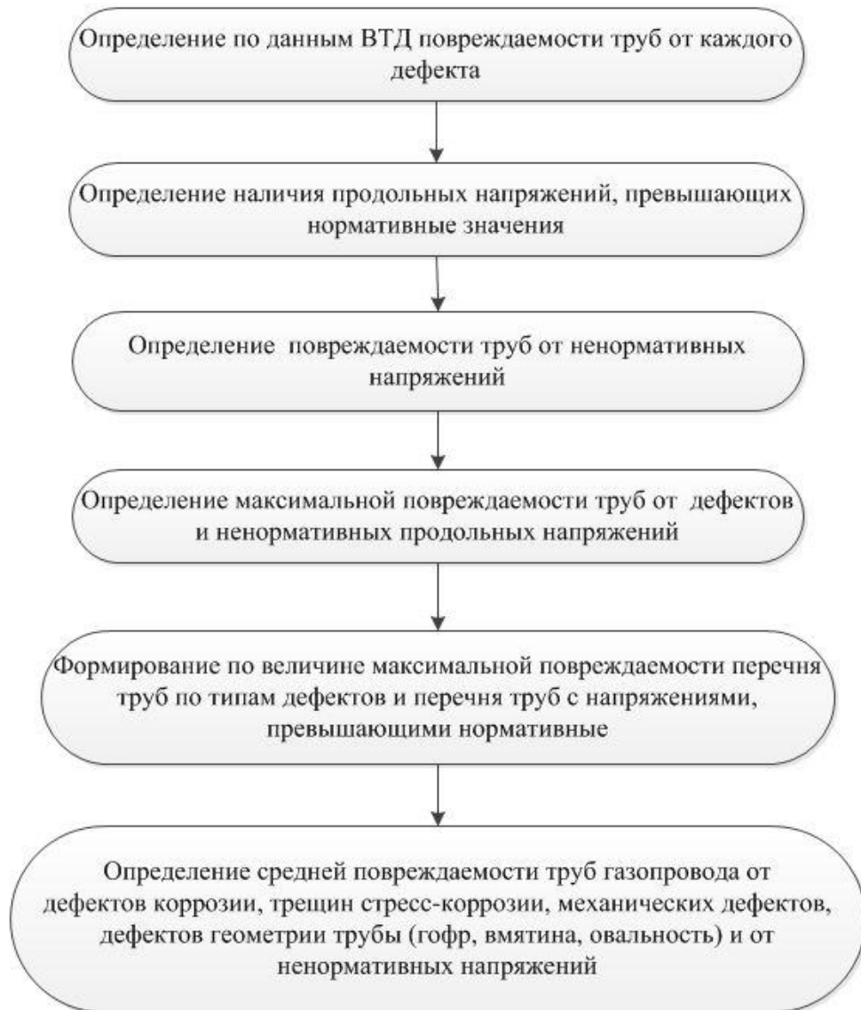
Рисунок 4.2 – Схема формирования перечня труб по максимальной их повреждаемости от дефектов и ненормативного уровня напряжений
