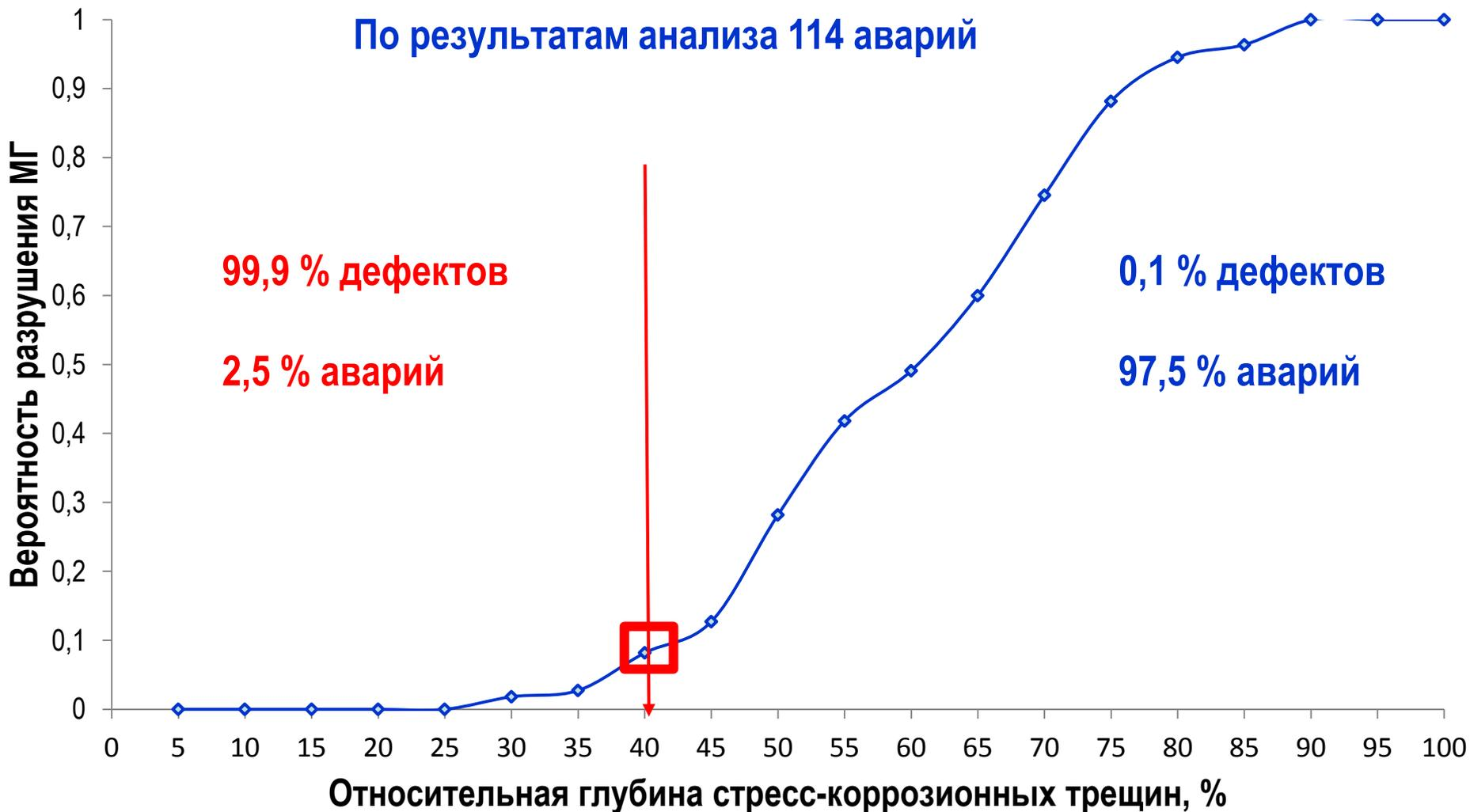
**Цель работы – обоснование работоспособности труб с дефектами КРН при условии исключения доступа грунтового электролита к поверхности металла трубы**
