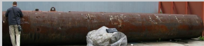
Работа на тестовом образце трубы с естественными и искусственными дефектами
