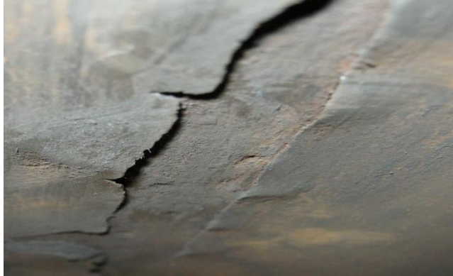
Расслоение с выходом на поверхность
