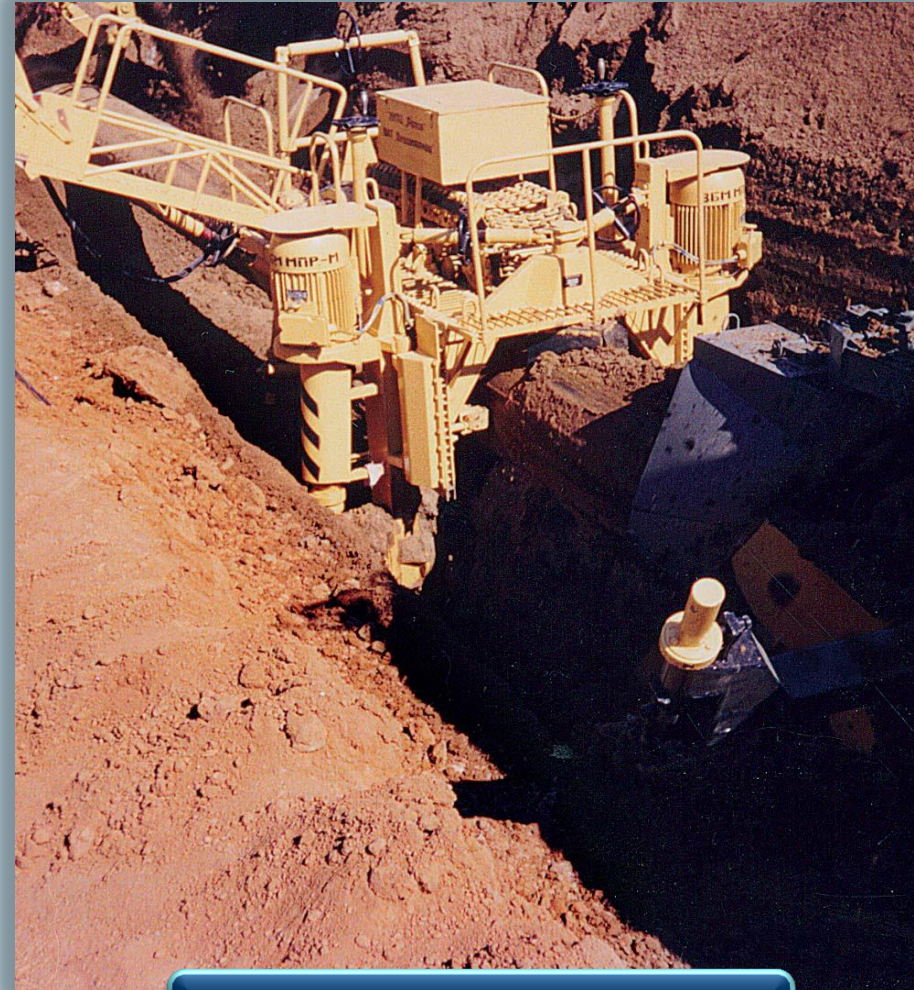
Подкапывающая машина МПР. (Рис. 4)
