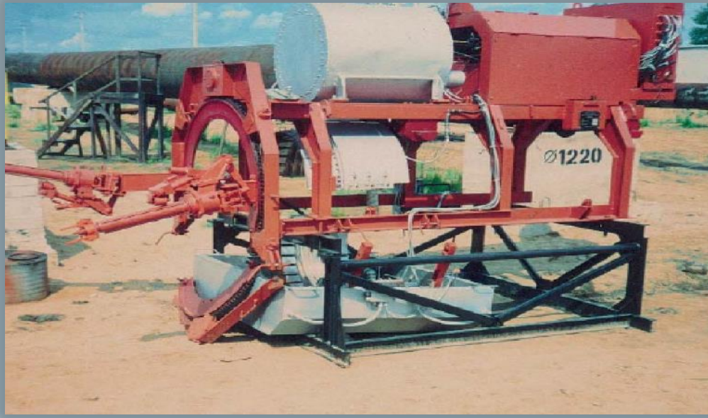
Изоляционная машина МИАБ-1220. (Рис. 7)
