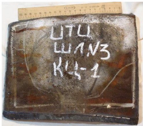
Темплет, вырезанный из трубы выходного шлейфа
