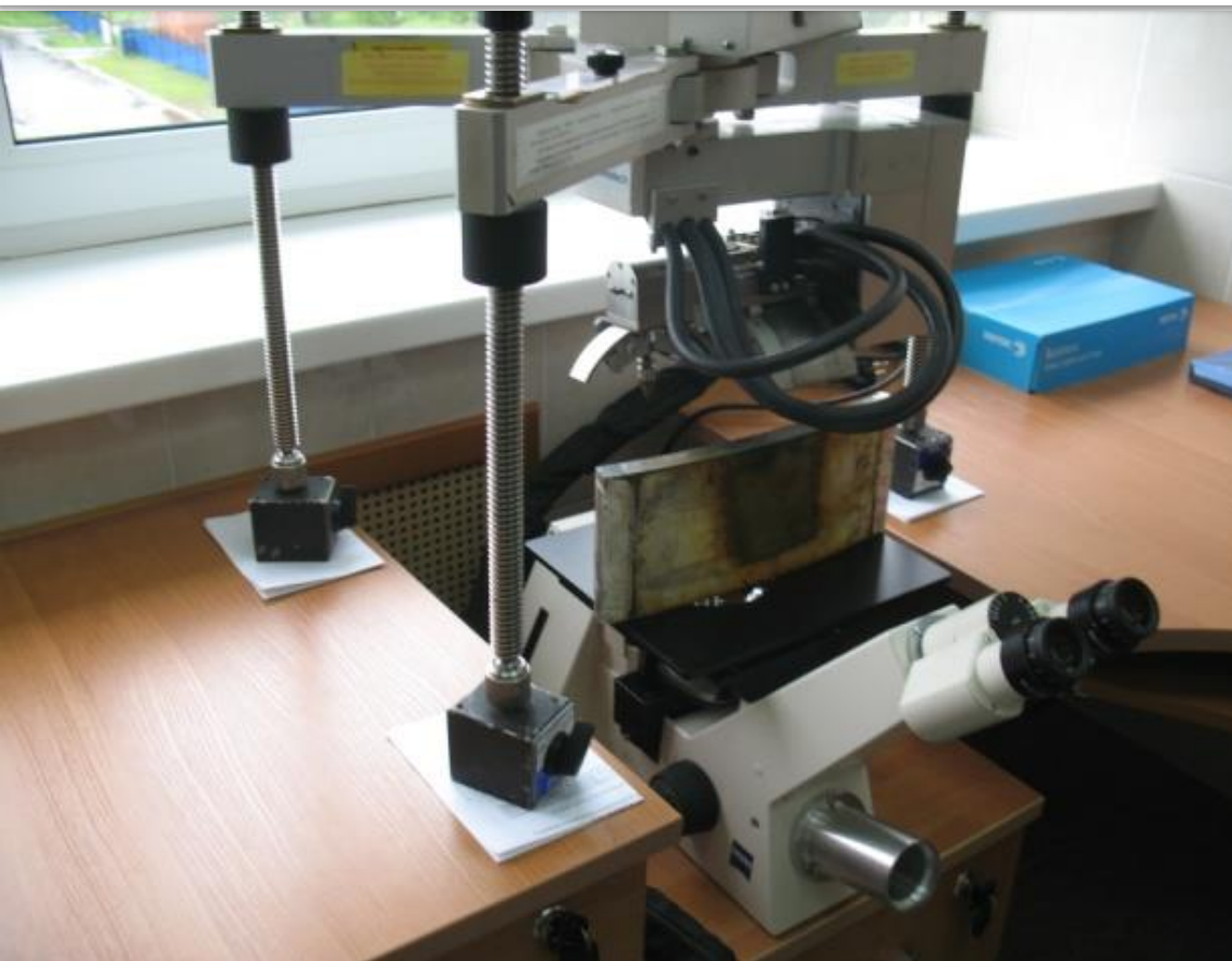
Схема измерений напряжений в вершине трещины.
