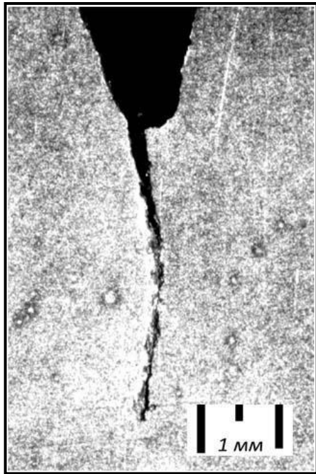
Общий вид и вершина трещин после испытаний при статической нагрузке
