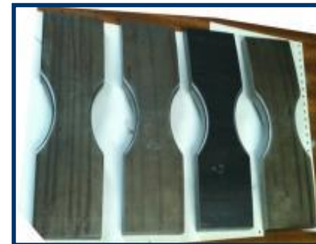
Эскиз и общий вид образца для проведения испытаний
