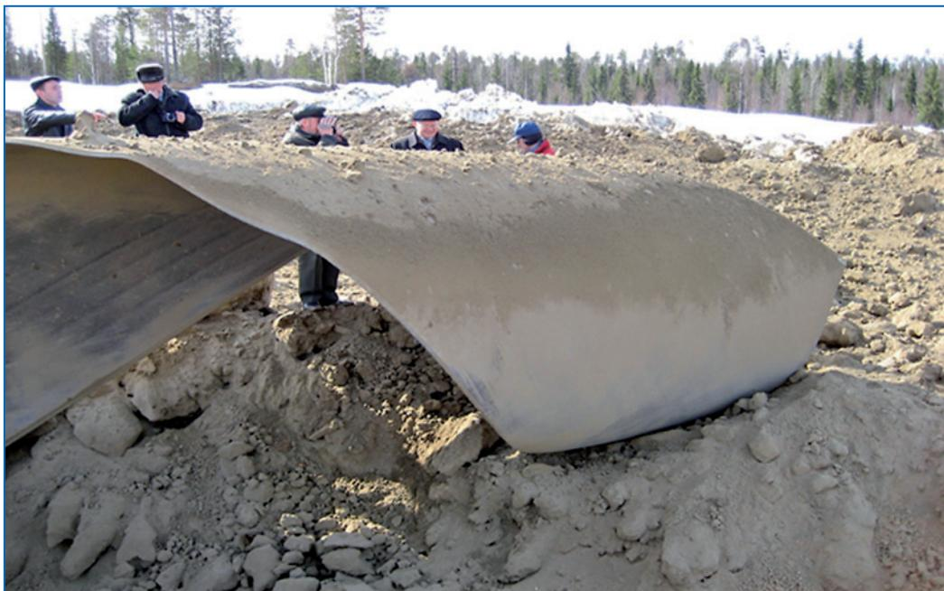
Разрушение спиральношовных труб диаметром 1420 мм
