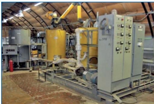
Опытная установка производства модифицированной серы
