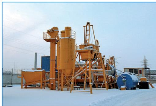
Опытная установка по производству сероасфальтобетона и серобетона
