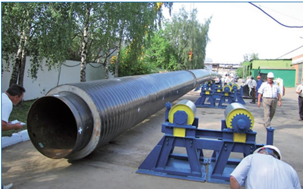
Испытание на изгиб обетонированной трубы в металлополимерной оболочке
