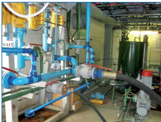
Стенд по отработке технологий эксплуатации газовых скважин на поздней стадии разработки месторождений
