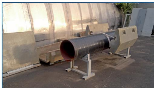
Отработка технологии производства пригрузов из серобетона
