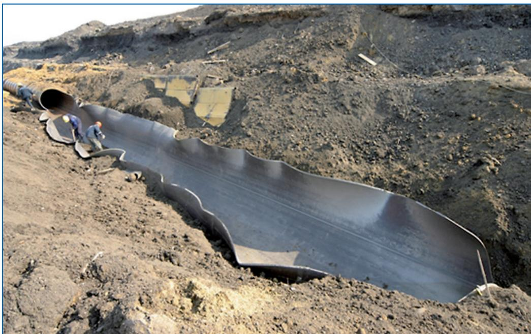
Испытания до разрушения труб производства ИТЗ (Россия) и NSC (Япония)
