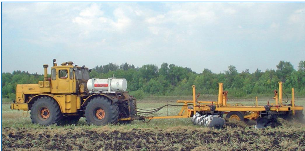
Опытный образец трактора К-700, работающего на СПГ
