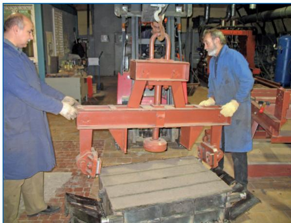
Отработка технологии производства бортового камня из серобетона
