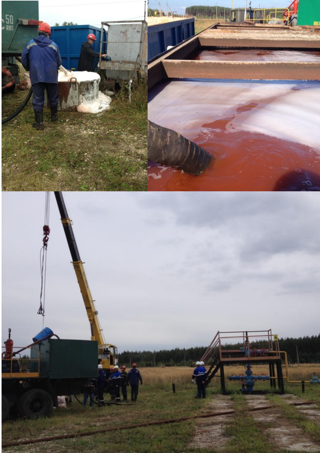
Рисунок 55 – Процесс приготовления раствора ПАВ
