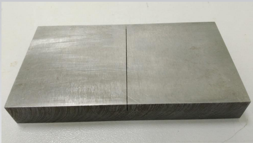
Образец толщиной 17,2 мм с переменной глубиной пропила от 3 до 5 мм
