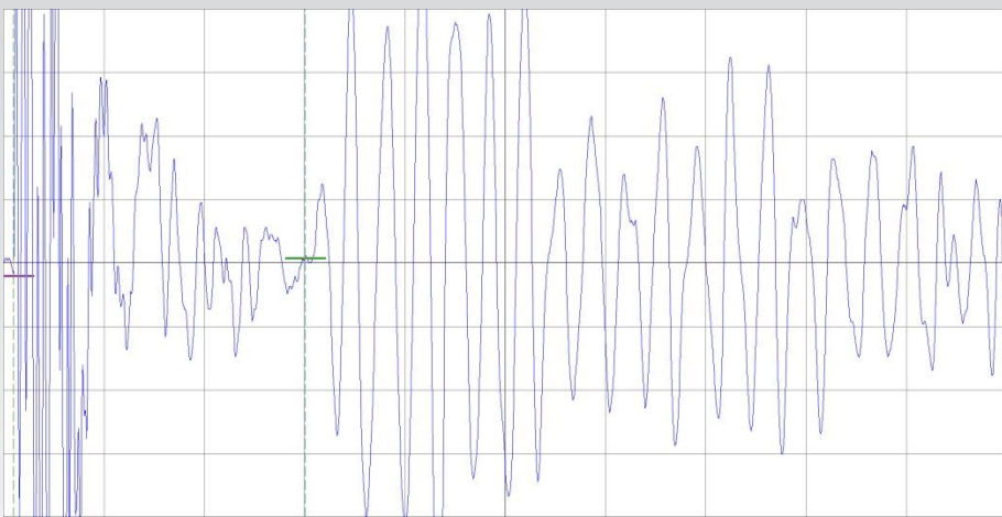
Трещина глубиной 2 мм, t = 2,91 мкс
