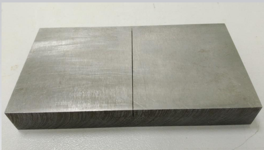
Образец толщиной 17,2 мм с переменной глубиной пропила от 5 до 7 мм
