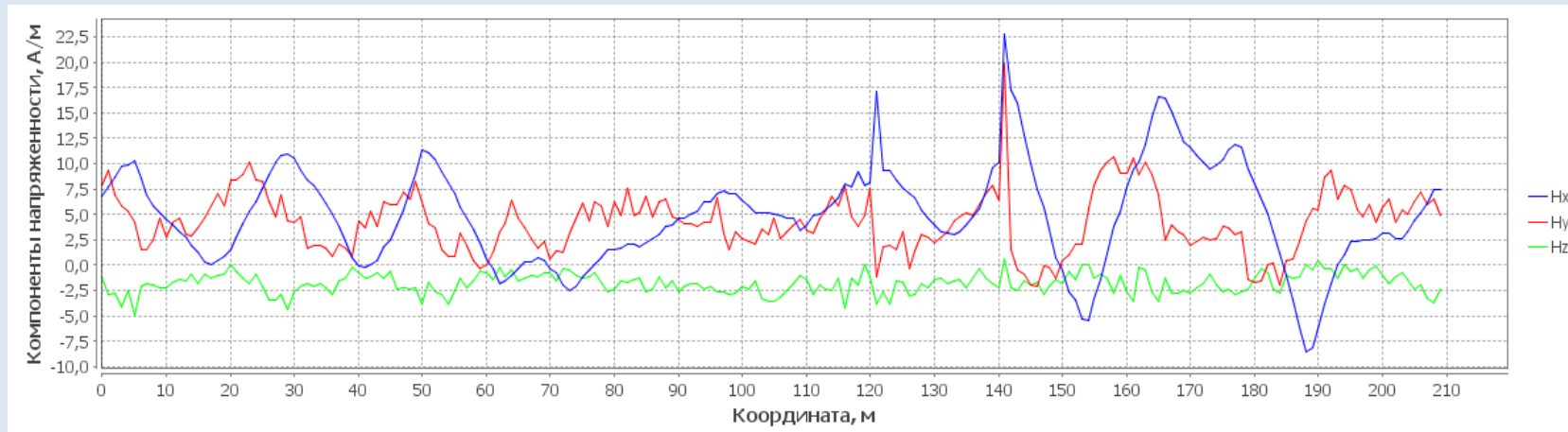
Графики компонент напряженности магнитного поля для участка магистрального нефтепровода «Холмогоры-Клин».
