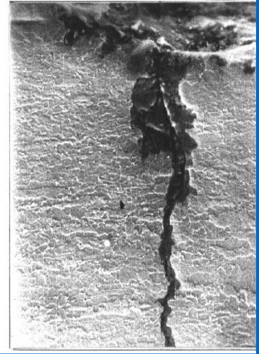
в – зарождение и развитие трещины от питтинга, поперечный шлиф стенки трубы трубы x 1500
