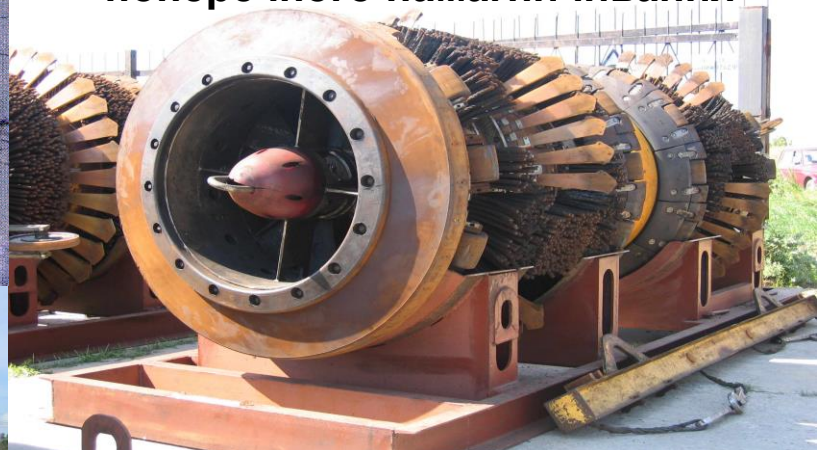
Внутритрубный магнитный дефектоскоп ДМТП-2Б-1200 поперечного намагничивания
