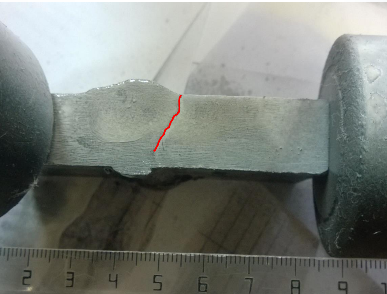
МАКРОШЛИФ ТРЕЩИНЫ НА ТРУБЕ № 13089 МГ УРЕНГОЙ-НОВОПСКОВ
