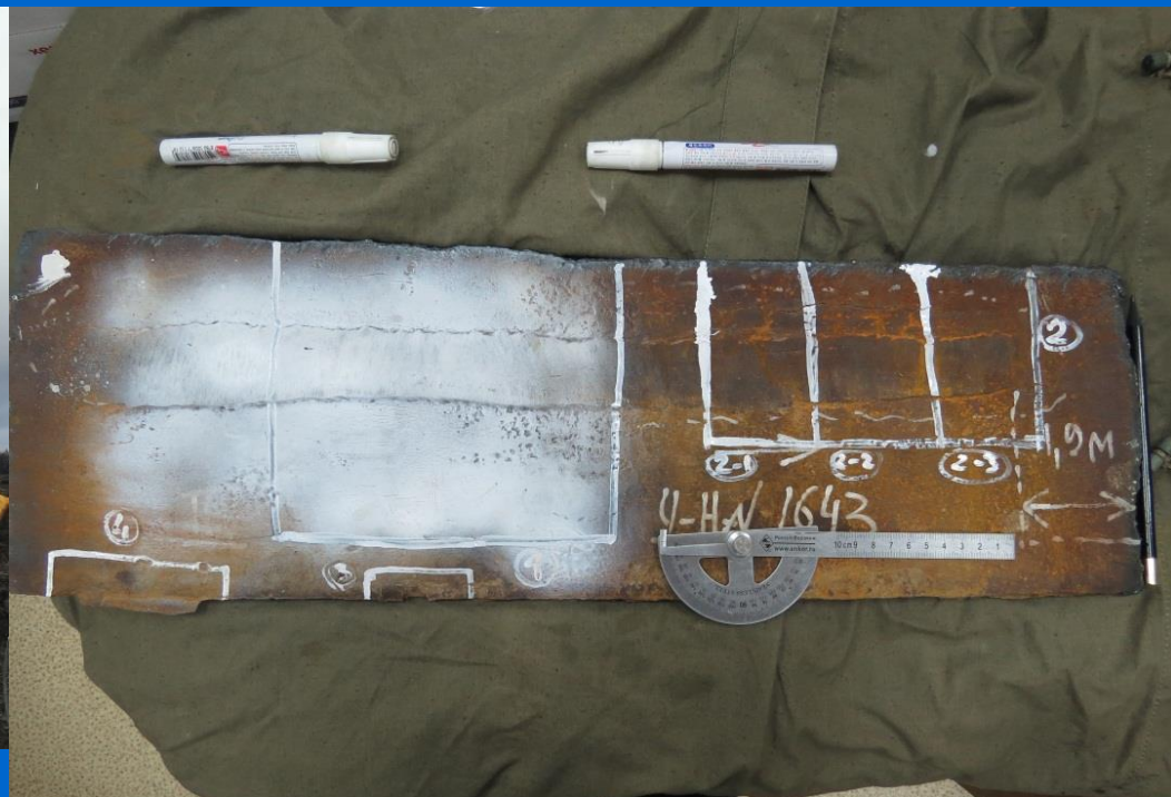
Темплет с трещинами КРН
