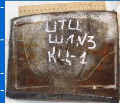
Темплет, вырезанный из трубы выходного шлейфа
