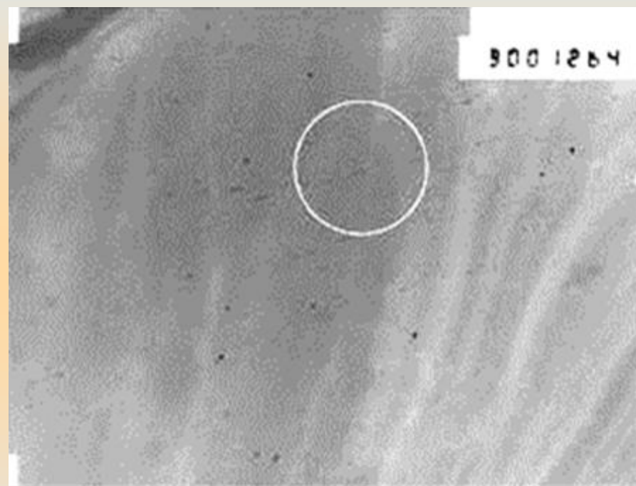
Межфазные выделения V(C,N) с цементитом в после термообработки
