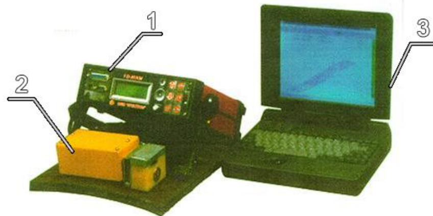
Многоканальный компьютеризированный вихретоковый дефектоскоп ВД-89НМ для обнаружения и записи оценок размеров стресс-коррозионных трещин. 1 – прибор; 2 – сканер с преобразователями; 3 – ноутбук.
