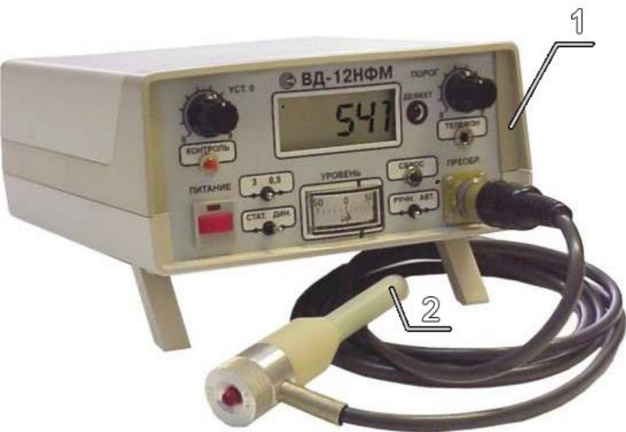
Вихретоковый дефектоскоп ВД-12НФМ 1 – прибор; 2 – датчик;
