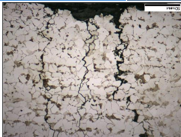
поверхность образца с трещинами (увеличение x500)
