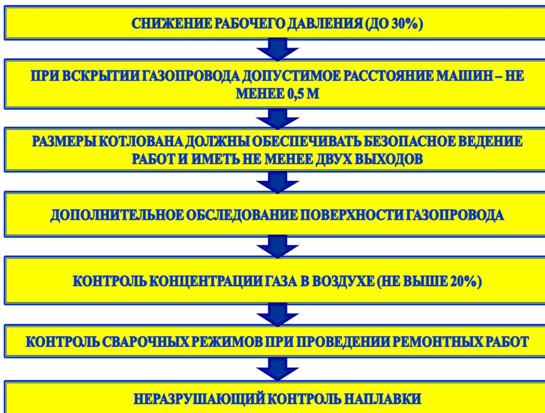
Рисунок 8 – Основные мероприятия по обеспечению безопасности при производстве ремонтных работ методом сварочной наплавки (СТО ГАЗПРОМ 14-2005)
