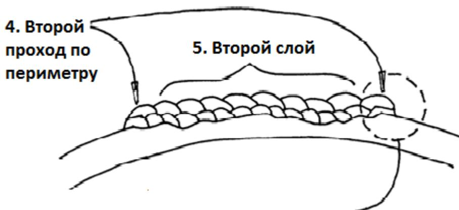
Рисунок 9в – Схема наложения слоя второго прохода. 4 - второй проход по периметру; 5 - второй слой; в пунктирном круге – подошва второго прохода по периметру как раз захватывает ступеньку, выполненную при шлифовке валика первого прохода. При втором проходе в базовом металле не возникает новой ЗТВ
