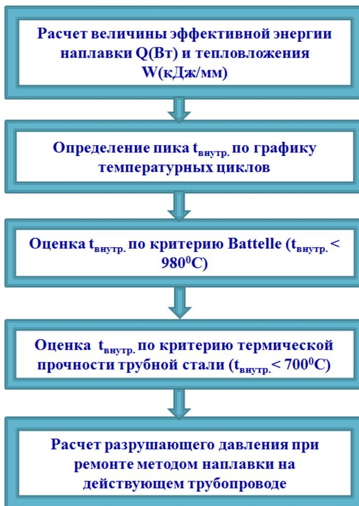
Рисунок 1 - Алгоритм оценки режимов ремонта методом сварочной наплавки
