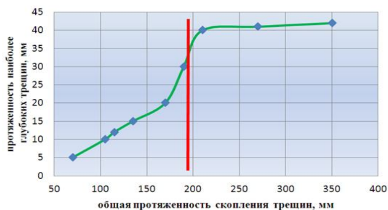
Рисунок 4 - Зависимость длины максимального дефекта от общей протяженности скопления трещиноподобных дефектов основного металла труб испытательного стенда.
