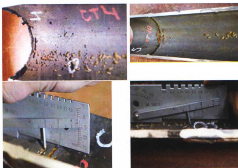
Рисунок 1.1 - Внутренняя поверхность нижней образующей участка газопровода на ЮНГКМ [70]
