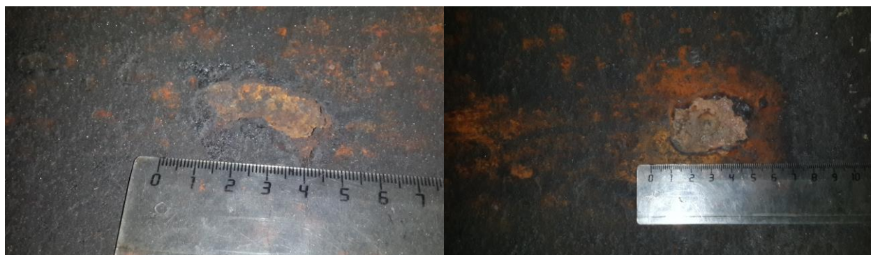
Рисунок 4.3 - Вид локальных дефектов разной формы на внутренней поверхности трубы после эксплуатации в условиях УКК [274]
